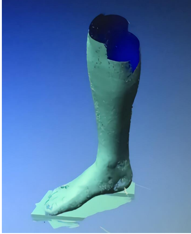
Şekil 5. FAROARM® Edge 2.7 üç boyutlu lazer tarama ölçüm cihazı ile elde edilen tarama
